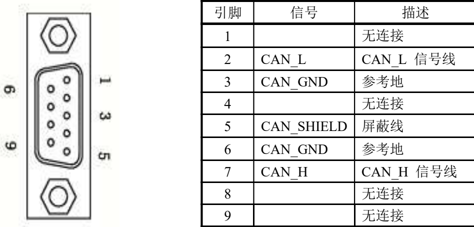
图 2-2 CAN 接口端子定义
