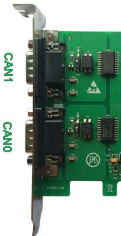
图 2-1 CAN 通道顺序示意图
